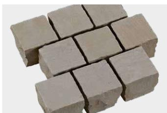
graues, mit z.T. bräunlichen Einschlüssen, Quarzsandsteinpflaster, Oberfläche geflammt, Unterseite gesägt mit geschlagenen Kanten, sehr maßhaltig und somit schnell zu verlegen
