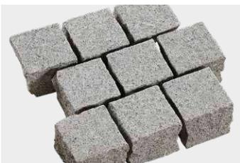
Hellgraues Reihenpflaster, Oberfläche geflammt, Unterseite gesägt, mit geschlagenen Kanten, sehr maßhaltig und somit schnell zu verlegen
