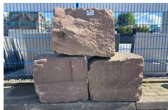
Sandstein, tiefrot/braun, gestoßen, in freien Längen von ca. 50 - 80 cm, allseitig spalt- bzw. bruchrau, auf v.g. Zirkamaße im Rahmen der Herstellungstechnisch bedingten Toleranzen gestoßen, sonst unbearbeitet
