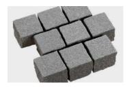
Dunkelgraues Reihenpflaster, Oberfläche geflammt u. gebürstet, Unterseite gesägt mit geschlagenen Kanten, sehr maßhaltig und somit schnell zu verlegen
