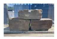
Grau bis braun, z.T. violett, gestoßen auf Maß, kantig mit zwei fast ebenen Lagerflächen, Restspuren der Materialzerteilung bzw. -bearbeitung möglich, Maßtoleranz ca. +/- 10 cm.
