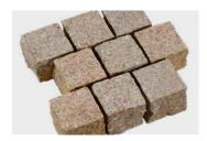
Gelbes Reihenpflaster, Oberfläche geflammt, Unterseite gesägt mit geschlagenen Kanten, sehr maßhaltig und somit schnell zu verlegen
