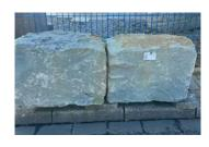
Quadersteine, grünlich bis grau, z.T. blau, gestoßen auf Maß, kantig mit zwei fast ebenen Lagerflächen, Restspuren der Materialzerteilung bzw. -bearbeitung möglich
